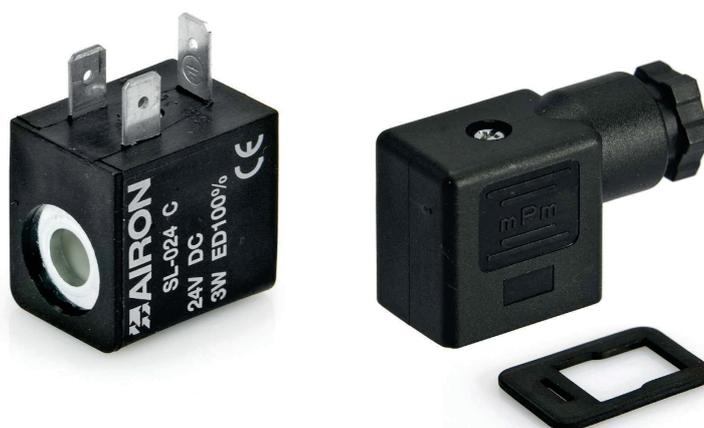
Le bobine della serie "SL" sono testate per l'impiego su tutte le valvole AIRON. Gli avvolgimenti in rame presenti all'interno rispettano la normativa IEC 317-13 in classe H. Questa caratteristica unitamente alla elevata qualità dei materiali che le compongono ne consente l'impiego al 100% del tempo.
